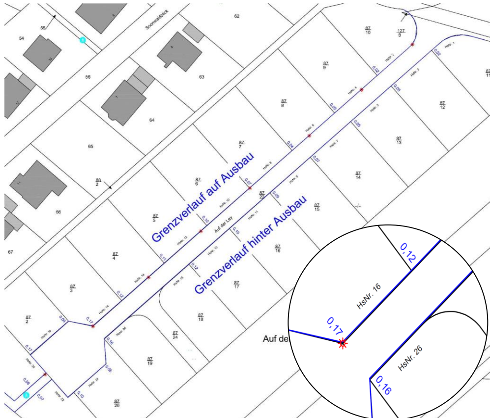
Abbildung 1: Abweichungen zwischen Planung und tatsächlichem Ausbau der Erschließungsstraße
