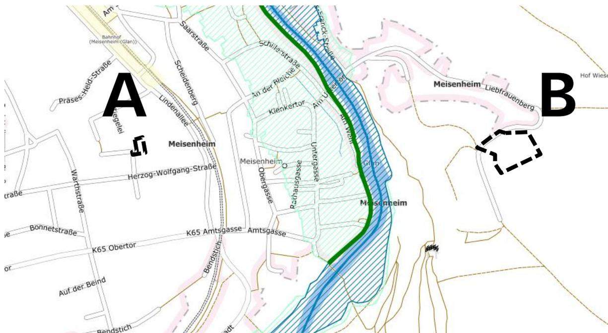
Abb. 8: Auszug aus dem Geoportal-Wasser mit Darstellung Überflutungs- und überflutungsgefährdeter Bereiche (blaue Schraffuren) in Relation zu den Teilbereichen.
