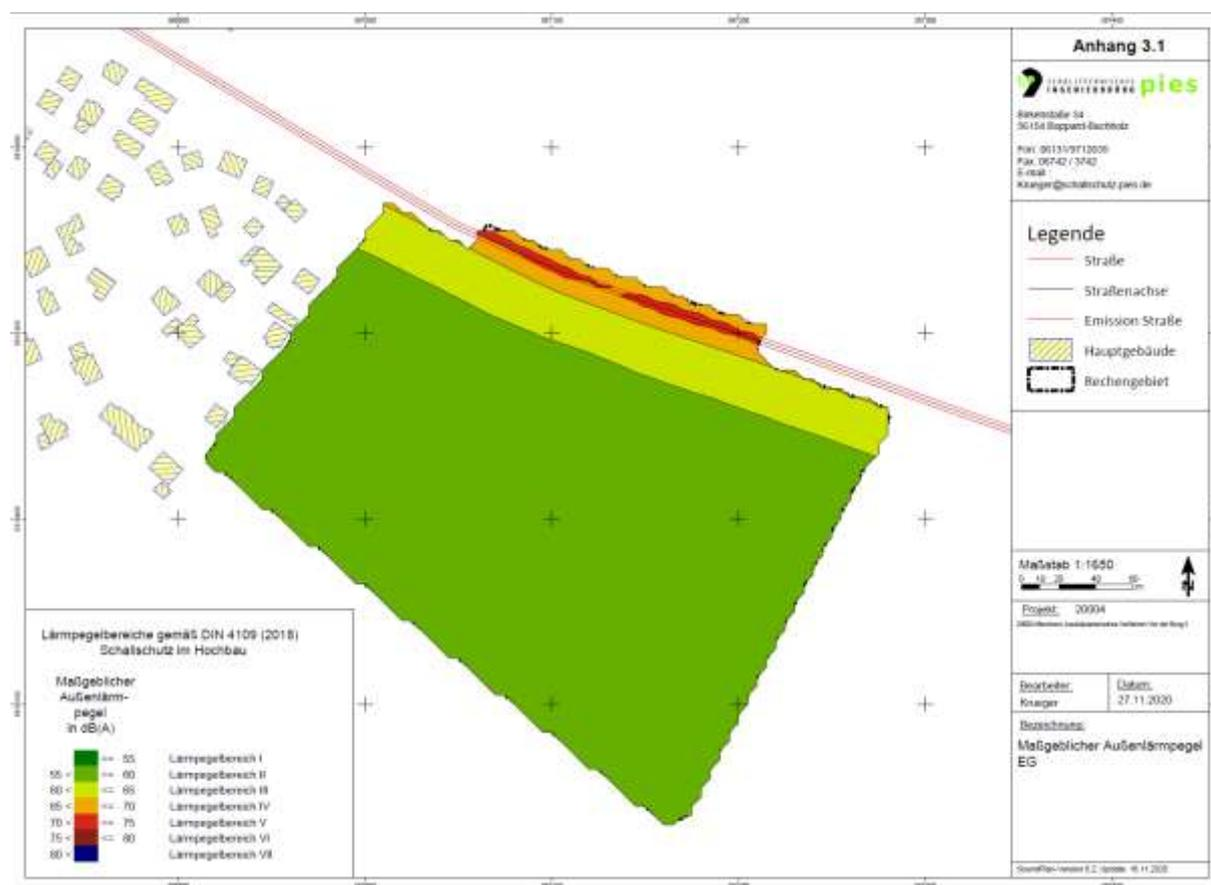
Abbildung 11: Maßgeblicher Außenlärmpegel und Lärmpegelbereich nach DIN 4109 (EG)
