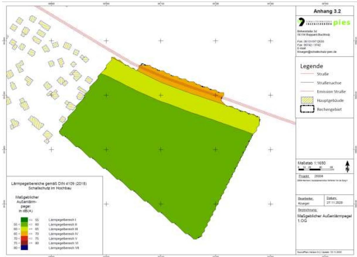
Abbildung 12: Maßgeblicher Außenlärmpegel und Lärmpegelbereich nach DIN 4109 (1.OG)
